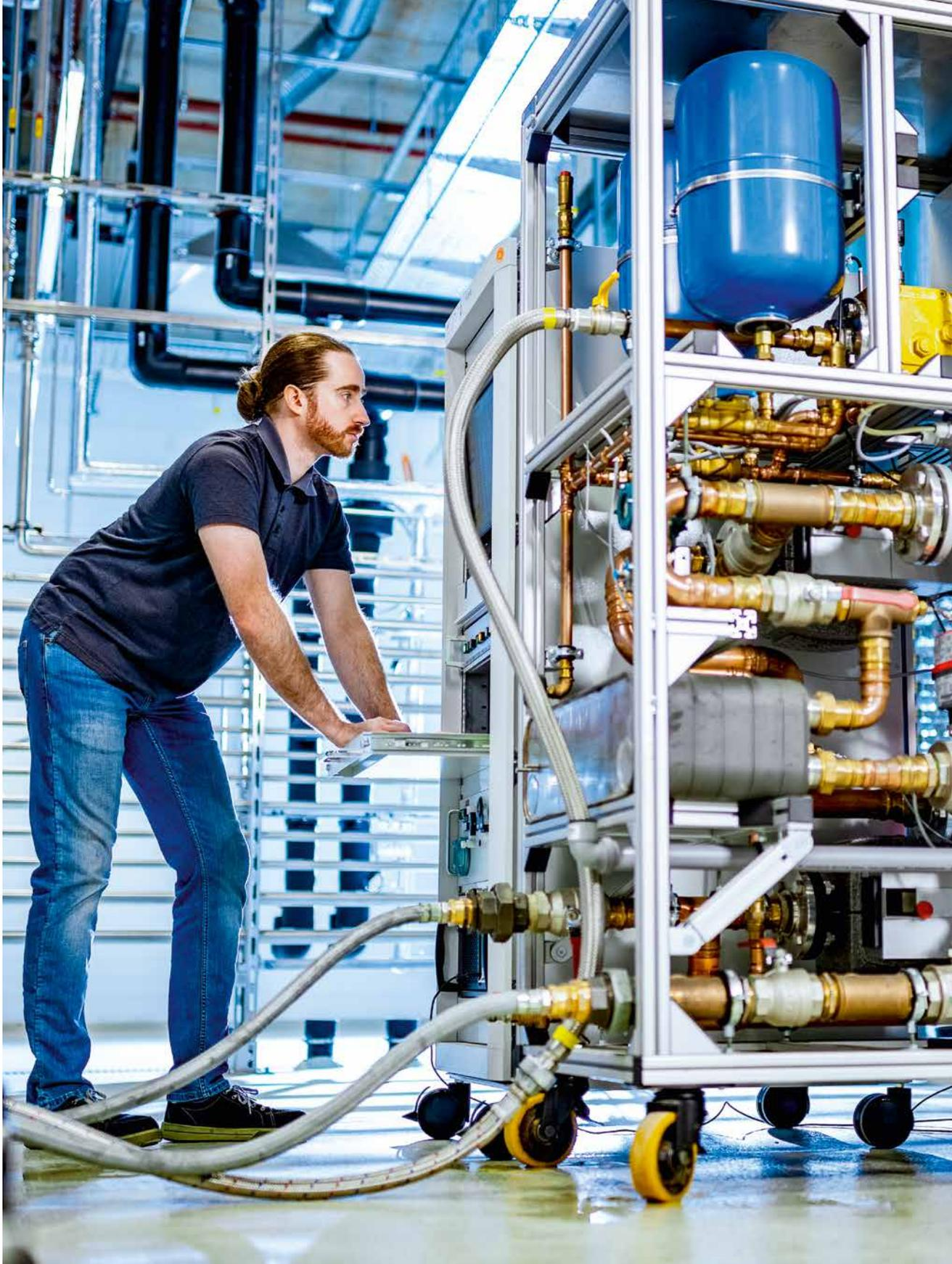
Die Vaillant Group entwickelt Heizgeräte für die Nutzung von Wasserstoff. Aktuell laufen im Test Center Betriebstests mit Gerätemodellen aus verfügbaren Produktserien und mit Bestandsgeräten. Geprüft wird unter anderem die Beimischung von Wasserstoff in unterschiedlichen Mengen. Darüber hinaus testen die Teams aus der Entwicklung der Vaillant Group ein serienreifes Gerät mit 100 Prozent Wasserstoff – als eine weitere Technologie mit dem Potenzial, zu einer kohlenstoffarmen Zukunft beizutragen.
