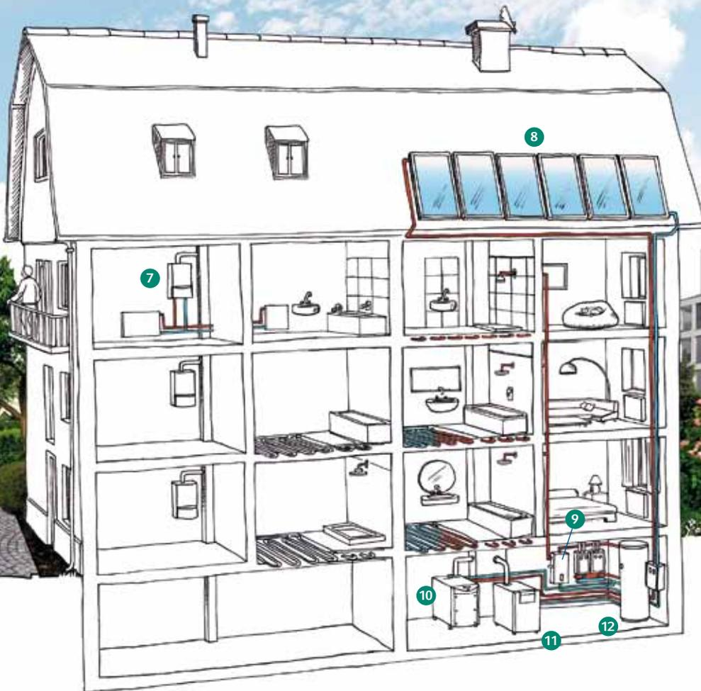
10 ▶ Das **Mini-Blockheizkraftwerk** ecoPOWER ist ein gasbetriebener Verbrennungsmotor, der einen Stromgenerator antreibt. Die bei der Stromproduktion durch Motor und Generator entstehende Wärme wird zum Heizen und zur Warmwasserbereitung genutzt. Und weil der Strom mit dem eigenen Kraftwerk im Keller genau dort produziert wird, wo man ihn braucht, entstehen keine Netzverluste.
