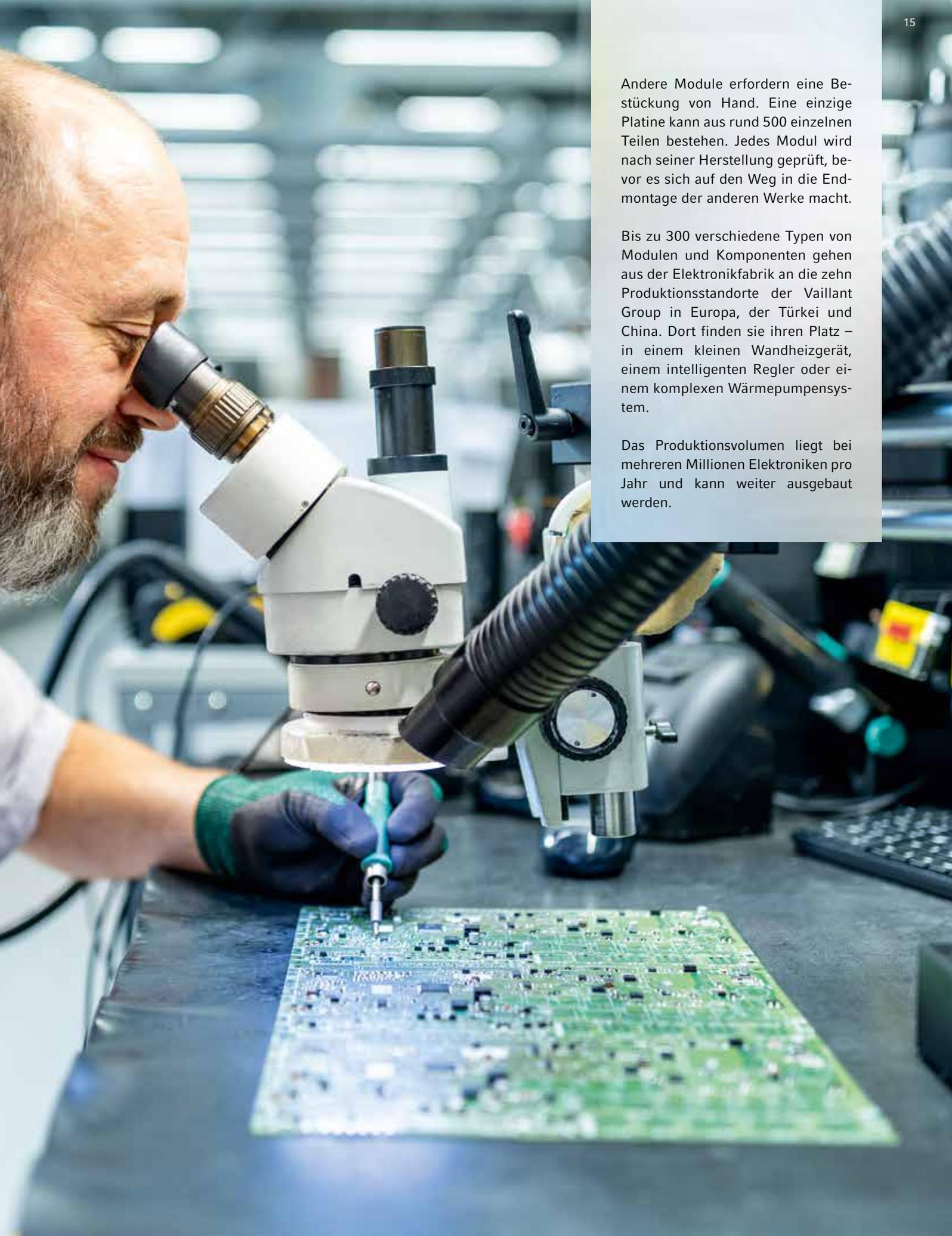
Andere Module erfordern eine Bestückung von Hand. Eine einzige Platine kann aus rund 500 einzelnen Teilen bestehen. Jedes Modul wird nach seiner Herstellung geprüft, bevor es sich auf den Weg in die Endmontage der anderen Werke macht.
